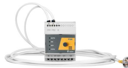
Q1 и Q2, через которые можно передавать информацию главной системе управления о состоянии работы коммутатора и некорректной работе датчиков.
