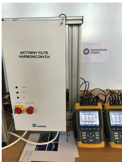
Rys. 1. Widok Aktywnego Filtru Harmonicznych na stanowisku pomiarowym w Instytucie Elektrotechniki Politechniki Śląskiej
