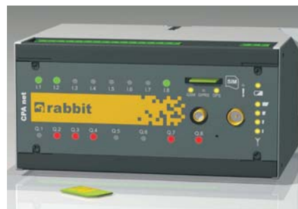
Rys. 2. CPA net – nowy system zdalnego monitorowania i zarządzania oświetleniem
